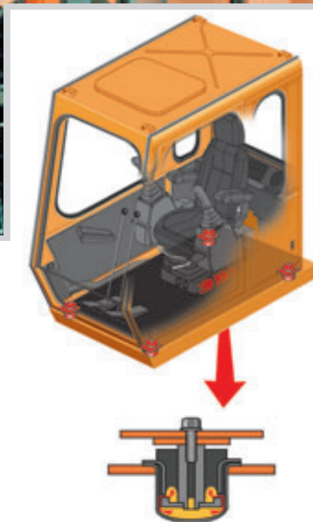
Гидропоры "Simrit" (Германия), эффективно снижающие вибрацию
