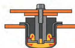
Гидропорты "Simrit" (Германия), эффективно снижающие вибрацию
